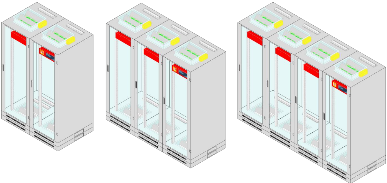
Rys. 7. Przykładowe warianty zespołu szaf połączonych bokami wyposażone w urządzenia gaśnicze.
